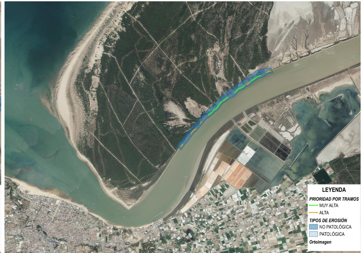
Figura 24. Zonas por tipo de erosión en el tramo Salinas – Broa. Fuente: Elaboración propia, 2022
