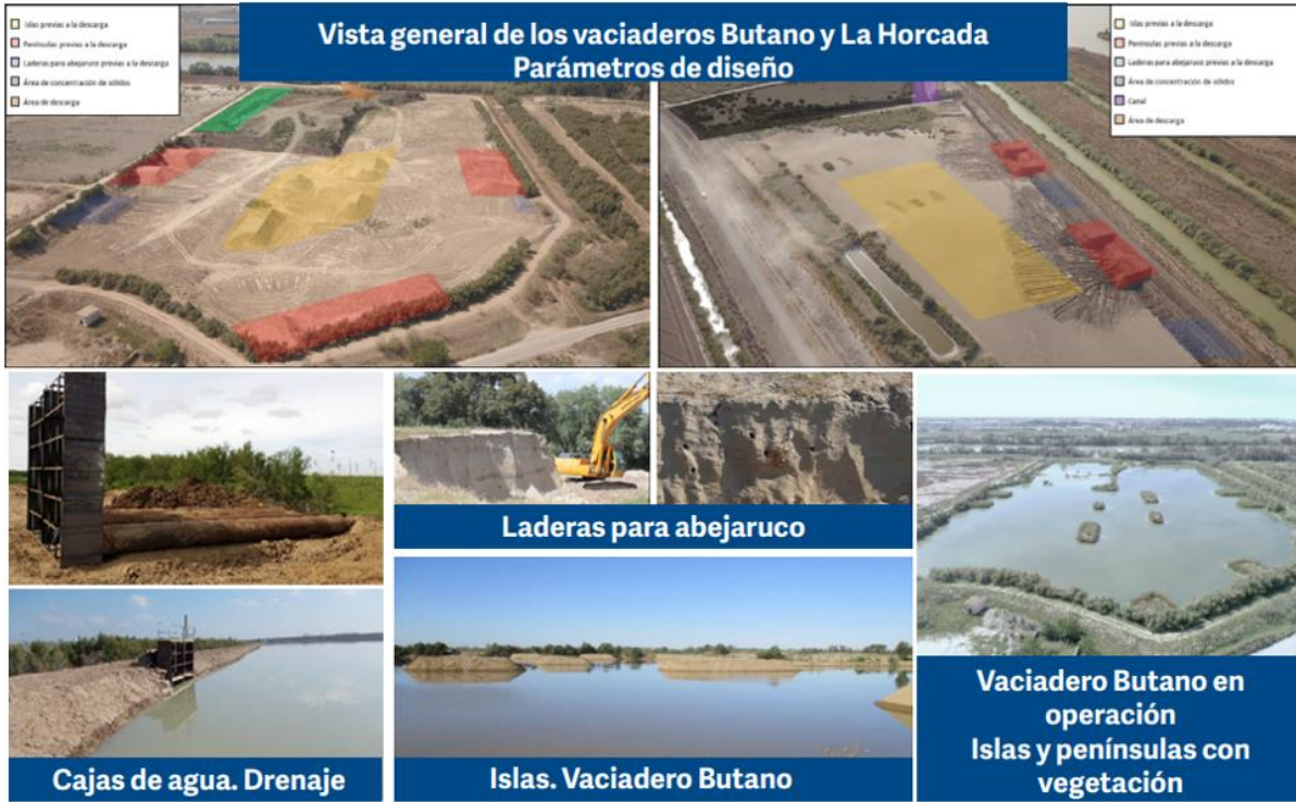
Ilustración 22. Secuencia de los trabajos realizados en los vaciaderos de Butano y La Horcada. Fuente: APS
