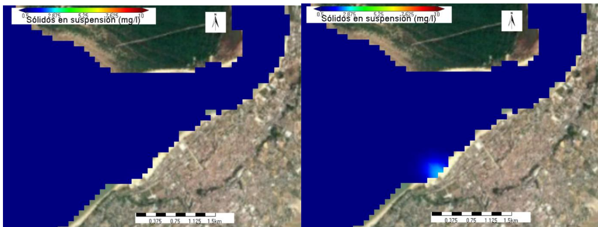
Ilustración 67. Sólidos en suspensión dos horas después de finalizar el primer aporte a la playa (iz) y al finalizar el segundo aporte a la playa (dcha). Fuente: Tecnoambiente, 2022.
