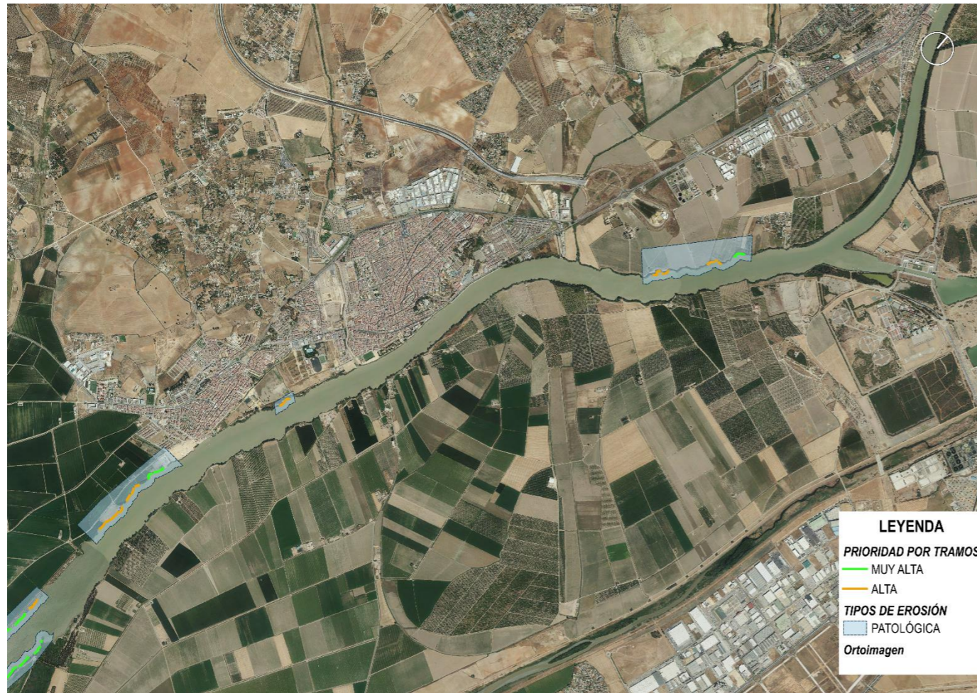
Figura 17. Zonas por tipo de erosión en el tramo Ant esclusa-Huertas-Coria del Río. Fuente: Elaboración propia, 2022
