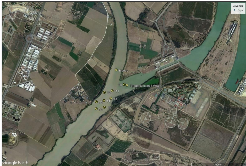
Ilustración 72. Diseño de malla de muestreo para el control de la pluma de turbidez en dragado. Fuente: Elaboración propia, 2022.
