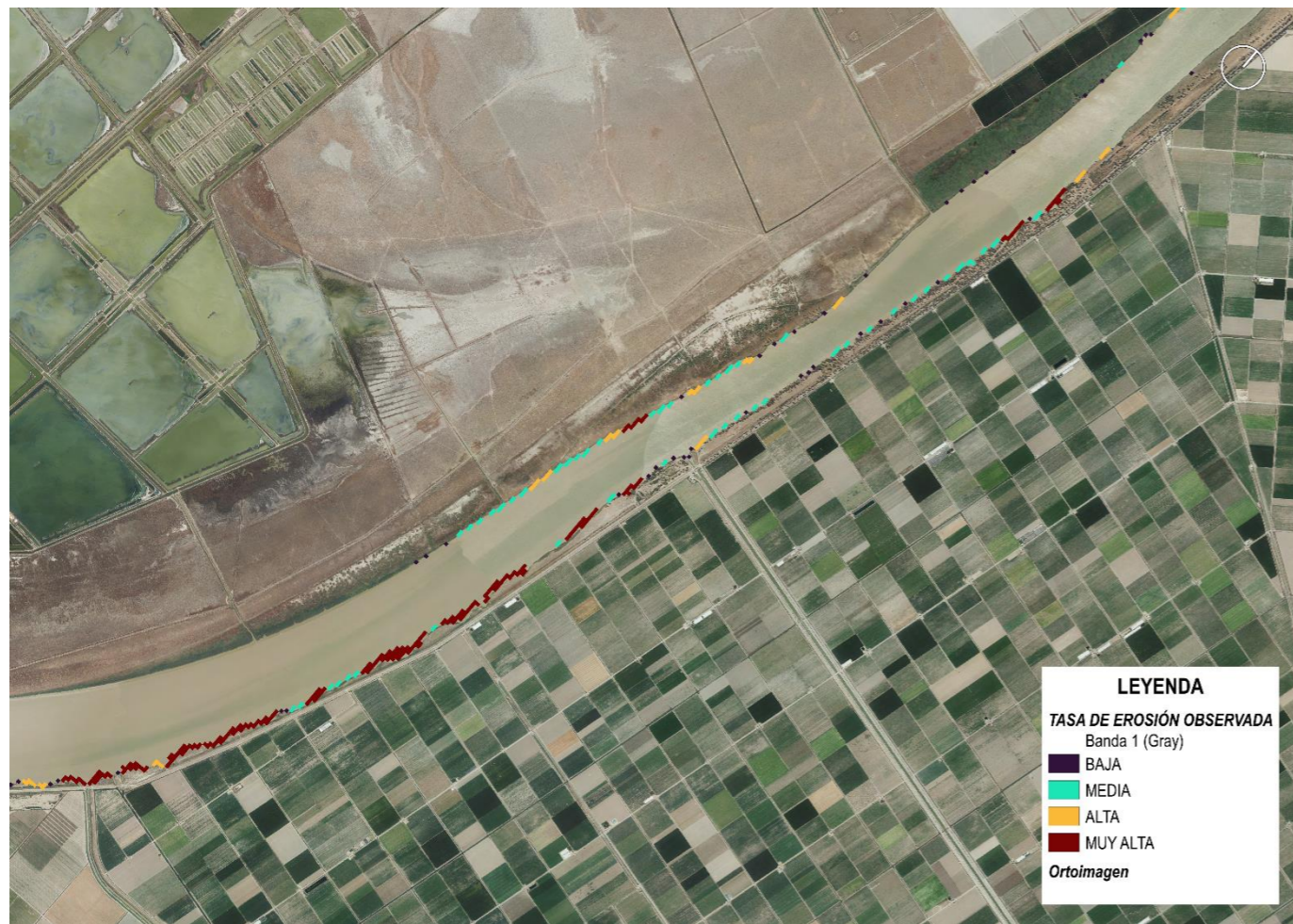
Figura 5. Tasa de erosión observada en el tramo Tarfía – La Gola. Fuente: Elaboración propia con base IH Cantabria, 2022
