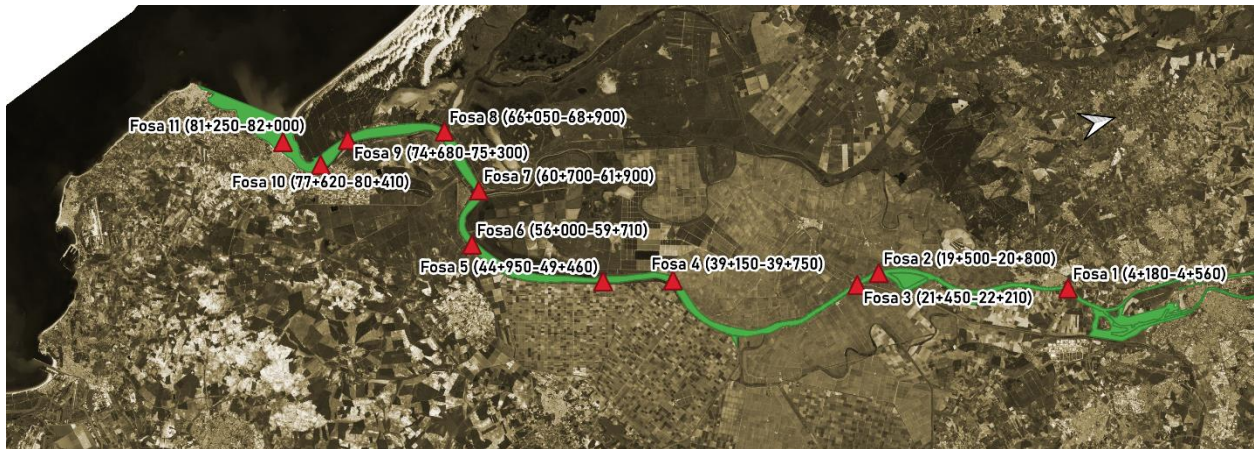
Ilustración 13. Ubicación en planta de las fosas localizadas a lo largo de la canal de navegación. Fuente: MC Valnera
